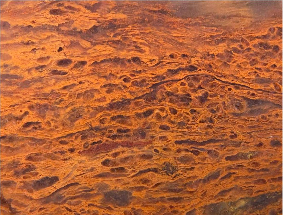
**Abb. 54** | Blasenbildung, vermutlich durch Zersetzungsprozesse, Bildbreite ca. 6 mm, Sammlungs-Nr. #0383.
