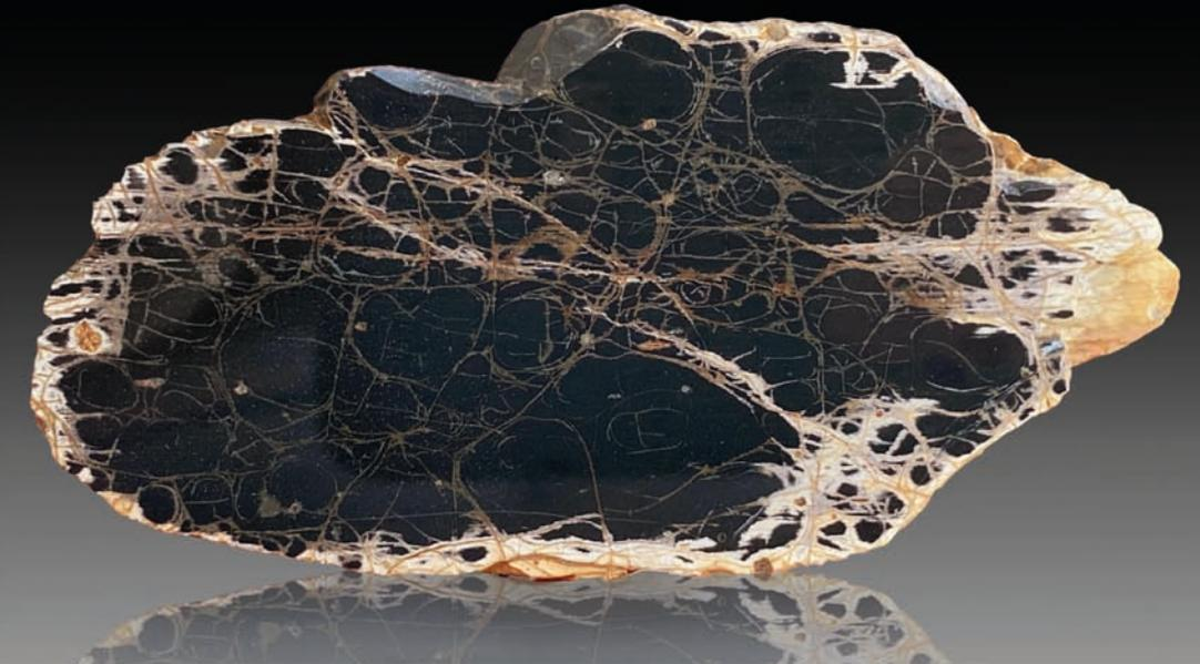
Abb. 4: Ursprüngliche Färbung des Materials von Mockzig mit höchstem vorgefundenen SiO<sub>2</sub>-Gehalt (vollständige Polierbarkeit des Materials vs. sonst nur teilweiser Polierbarkeit) mit Entfärbungs- und Entglasungserscheinungen entlang der Risse. Auch hier sind horizontale Linien sichtbar, die eine gebänderte Schichtung zeigen, Größe ca. 9 × 4,5 cm.
