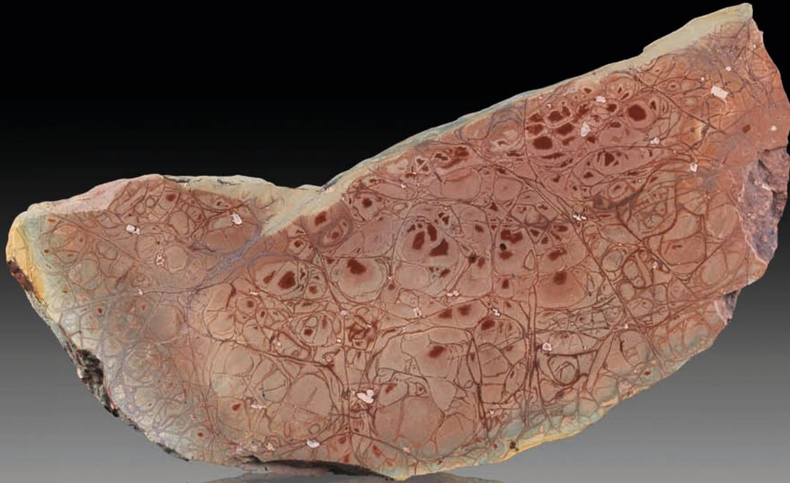
Abb. 7: Stück von Mockzig mit typischer, relativ einheitlicher brauner und grüner Färbung und fortgeschrittener Entfärbung und Entglasung, die sich in seidenweicher Polierbarkeit niederschlägt, Größe ca. 6×15 cm.
