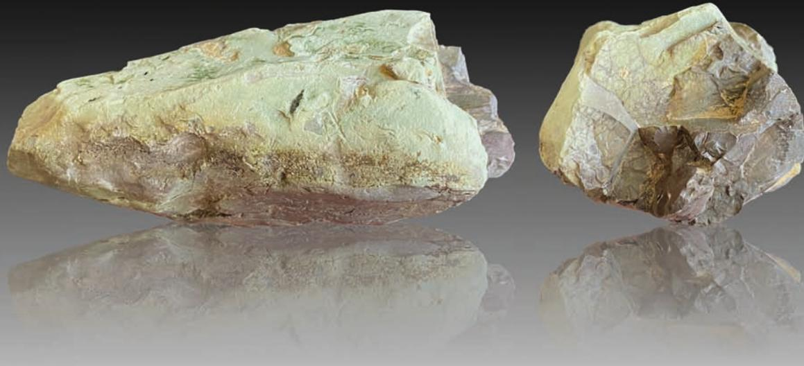
Abb. 2: Rohstück in amorpher Ausbildung, auf der rechten Seite ein typischer Querschnitt mit perlitischen Rissstrukturen, Größe ca. 11 × 4 × 5 cm.
