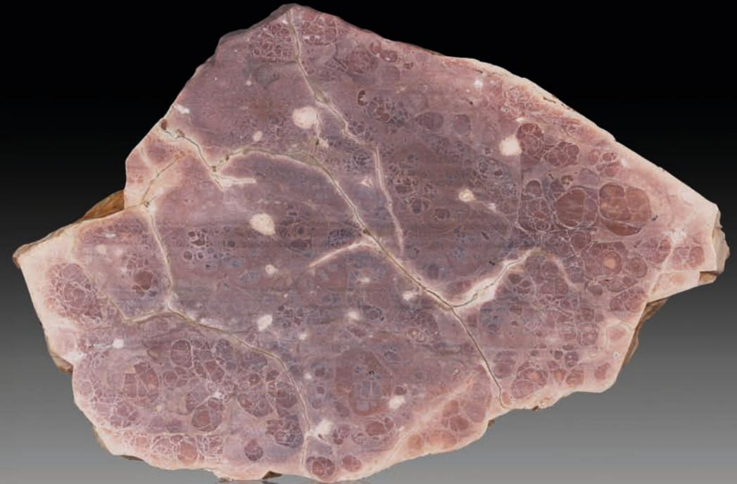
Abb. 9: Stück von Priefel in typischer gelb-violetter Färbung (mit gebänderter Schichtung) und weit fortgeschrittener Entfärbung und Entglasung, die sich in matter Polierbarkeit niederschlägt, Größe ca. 11×7,5 cm.
