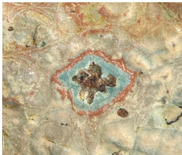
Abb. 17: Details aus Abb. 15, Beispiel für Färbungserscheinungen unabhängig von perlitischen Rissen, BB ca. 13 mm.
