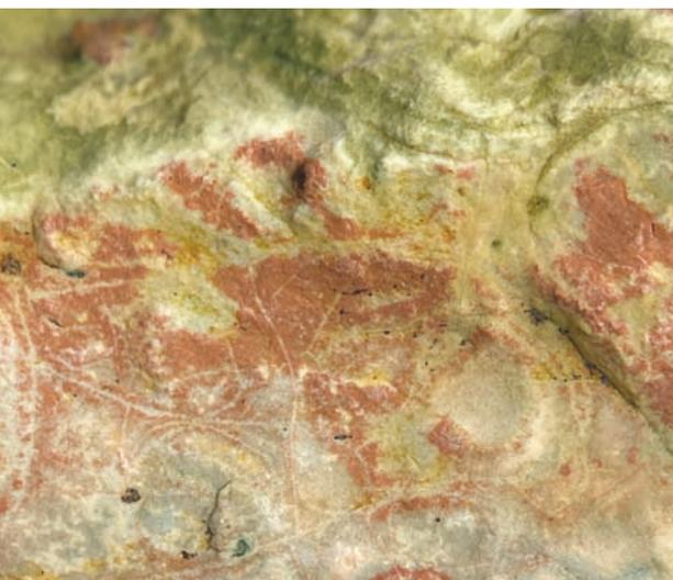
Abb. 16: Details aus Abb. 15, Beispiel für Färbungserscheinungen unabhängig von perlitischen Rissen, BB ca. 19 mm.
