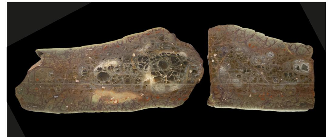
Abb. 19: Zufallsfund auf einem Feldweg südlich von Mockzig – ein ehemals zusammenhängendes Stück Perlitischen Rhyoliths, bei dem ein Band die Zusammengehörigkeit beider Stücke anzeigt und an denen Zerfallserscheinungen abgelesen werden können. Die Stücke waren ca. 30 Jahre lang der oberflächennahen Witterung ausgesetzt. Bildbreite ca. 18 cm.
